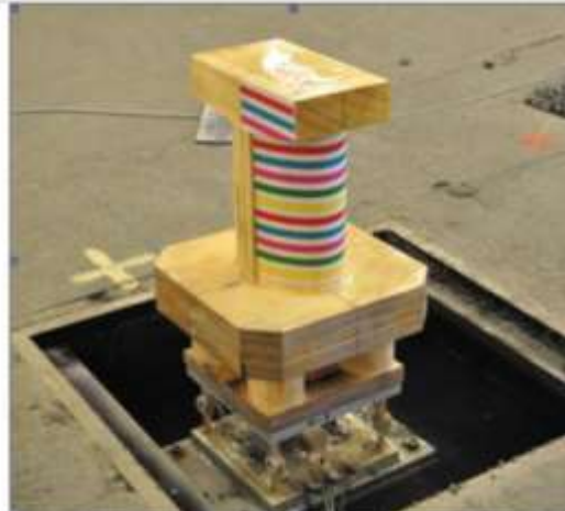
Figure 7 : Pile n°55 équipée d'une balance pour mesurer les efforts
