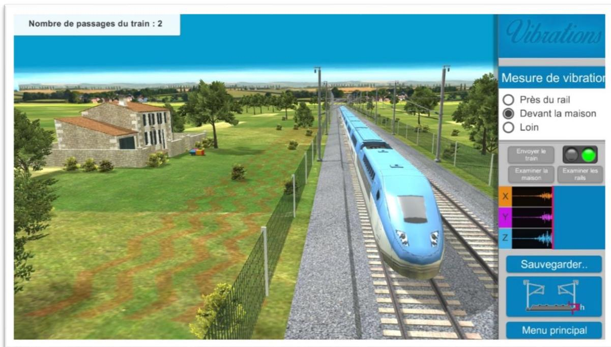
Il compare, les vibrations devant la maison au passage du TGV sans protection (ballast le plus fin), aux normes et conclut sur le besoin de réduction des vibrations.
